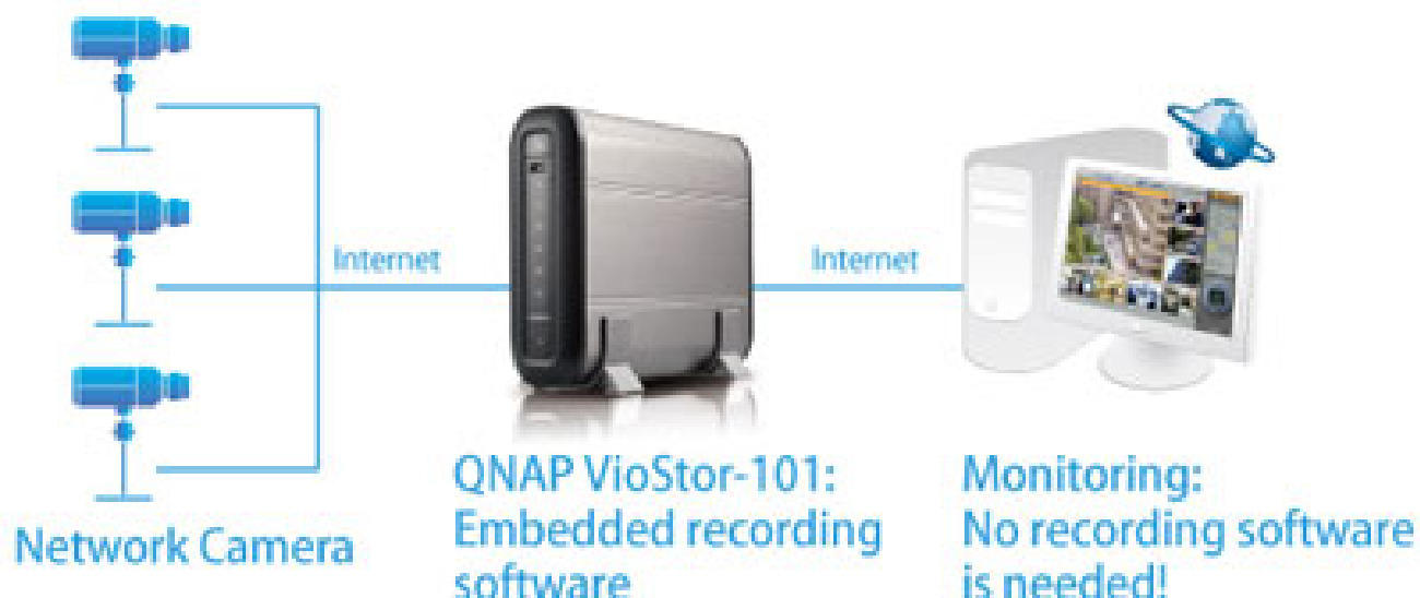
Rys.52 Schemat odbioru on-line obrazu z kamer monitorujących na komputerze, przez sieć internet.
